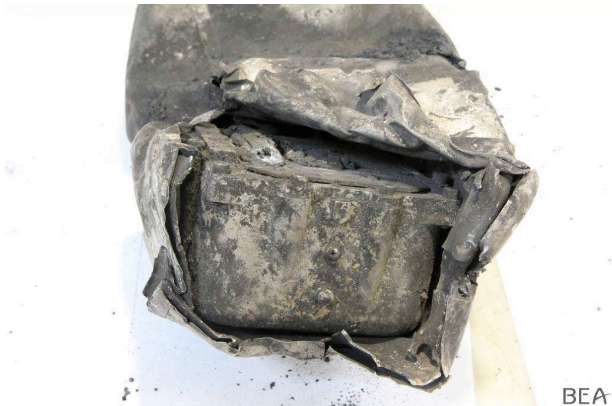
Das Gehäuse des Digital Flight Data Recorders (DFDR)
